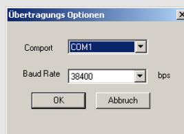
Abbildung 8 - Einstellung von COM-Port und Baudrate
