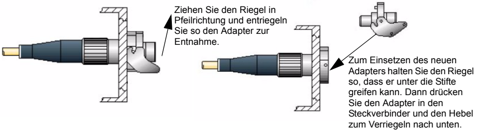
Abb. 12 Ausbau und Einbau eines Adapters
