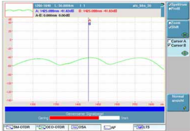
Abb. 69 Beispiel einer Spektrumsansicht im Anschluss an eine Messung
