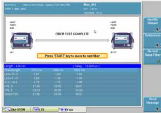
Abb. 91 Ergebnis einer automatischen FOX-Messung
