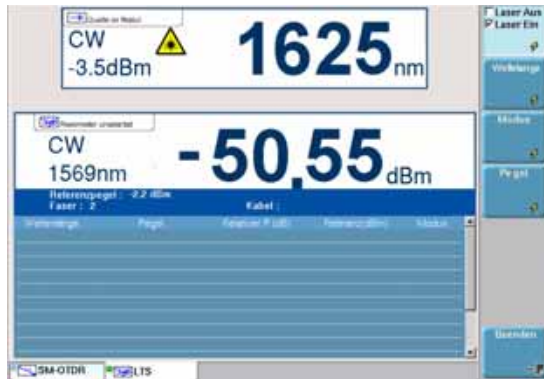
Abb. 82 Konfiguration des Lasersenders
