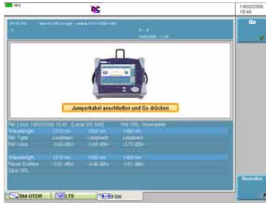
Abb. 87 Referenzmessung für ORL-Messung
