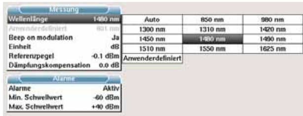
Abb. 81 Konfiguration der Pegelmessung
