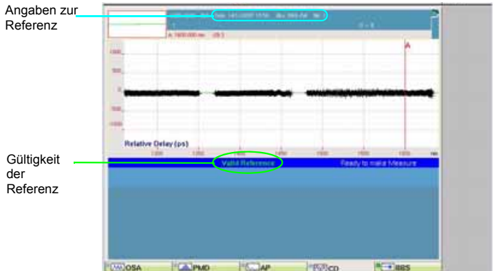
Abb. 75 Beispiel einer korrekten Referenzmessung mit angezeigten Messpunkten
